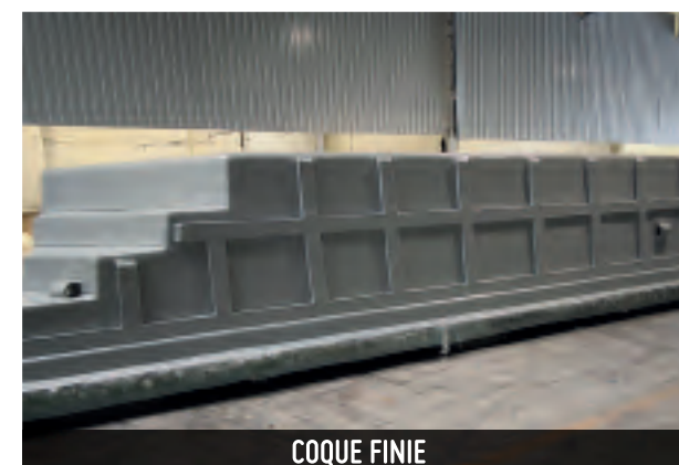
PROJECTION SIMULTANÉE DE FIBRE DE VERRE ET RÉ- SINE, POSE D'UN TISSU ROVING AU COEUR DE LA STRUCTURE, MISE EN PLACE DES RENFORTS
